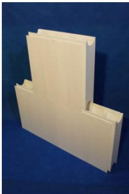
**ModulWall** es un Encofrado Modular Final donde se modela el muro requerido acorde a la necesidad, se insertan las instalaciones, se efectúa el colado, se limpia y queda como revestimiento final, habilitándose de inmediato su puesta en servicio. Sin mayor mantenimiento que su limpieza, mediante agua y detergente. Debe agregarse que de provocarse alguna fisuración, esta quedará oculta y por estar protegida no presentará oxidación de armaduras en ambientes de alta salinidad.
