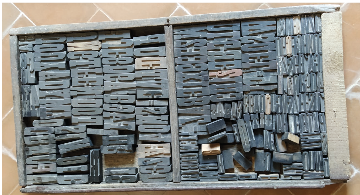
4- cajón con dos divisiones igua- les, contiene 130 tipos móviles de madera.
