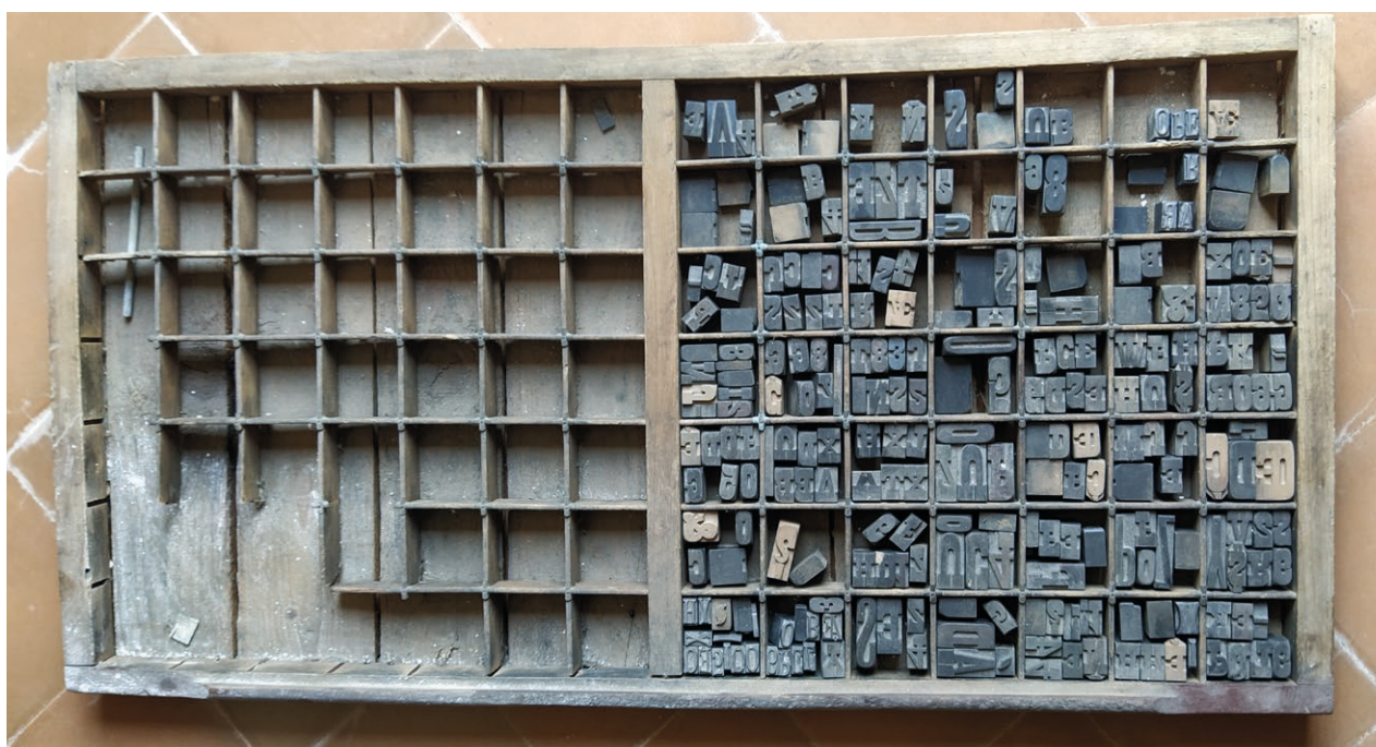
1- cajón de 98 cajetines, contiene 250 tipos móviles, (plomo y de madera)
